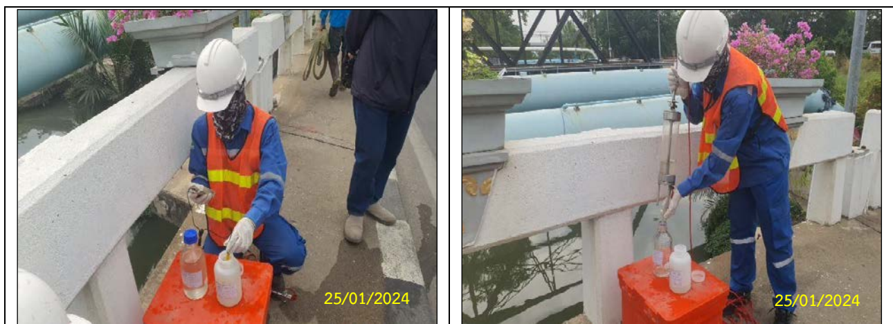
ก) ดำเนินการตรวจวัดคุณภาพน้ำ ก่อนนำมาทดสอบท่อ ฯ
