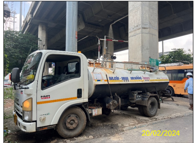
ค) การจัดเตรียมรถดูด Vacuum ที่มีลักษณะปิดมิดชิด สำหรับขนส่งโคลนโซเดียมเบนโทไนท์
