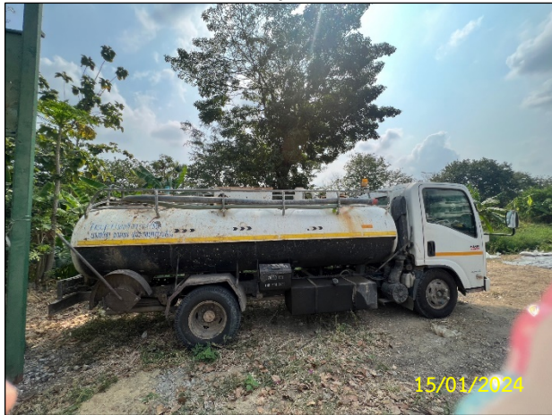
ค) การจัดเตรียมรถดูด Vacuum ที่มีลักษณะปิดมิดชิด สำหรับขนส่งโคลนโซเดียมเบนโทไนท์
